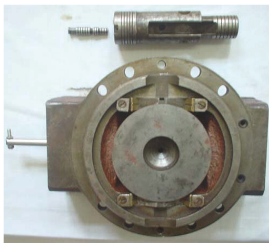
图 2 伺服变量机构实物
