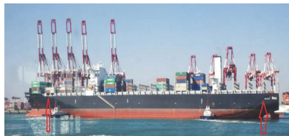
图8 拖力作用点示意图
