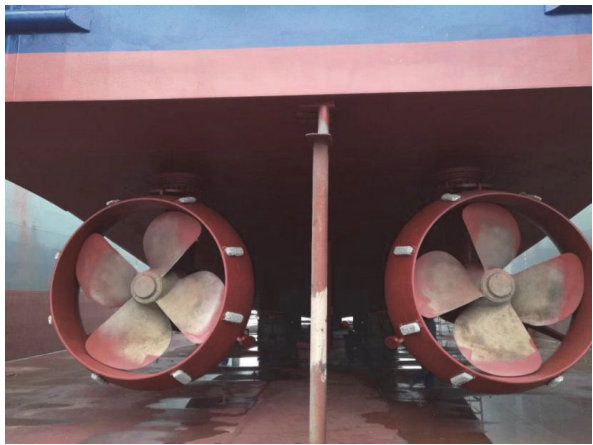
图 1 Z 型全回转拖轮螺旋桨
