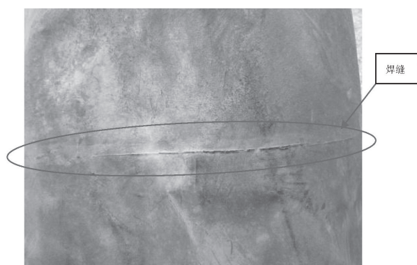
图 3 涂塑层背面焊道痕迹
