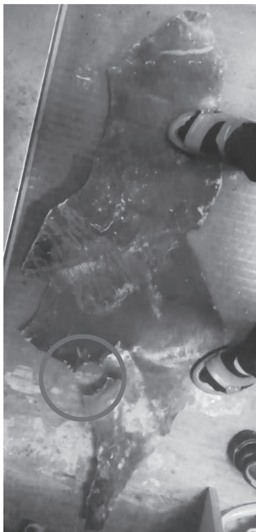
图 6 带有规则圆洞的脱塑层
