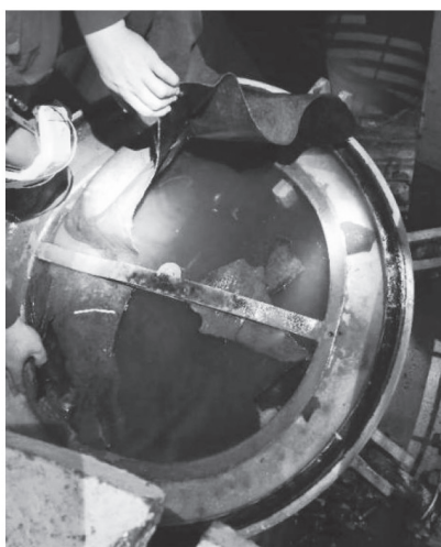
图 2 脱落的涂塑层糊住了滤器
