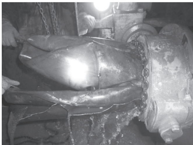
图 1 脱落的涂塑层卡在了阀门处
