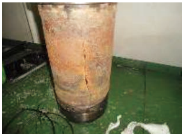
图 1 NO.6 缸套裂纹
