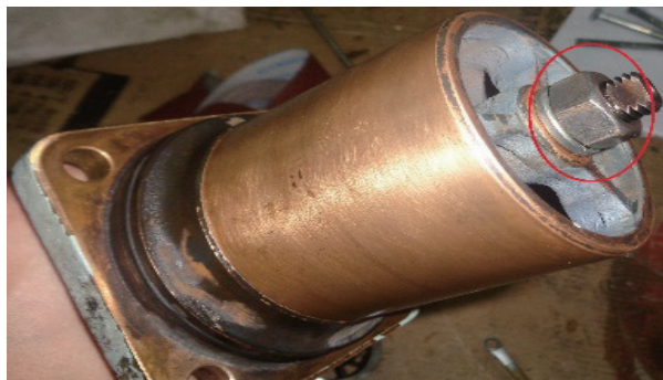
图 9 冷却水选择阀锁紧螺母换新（圈定处）
