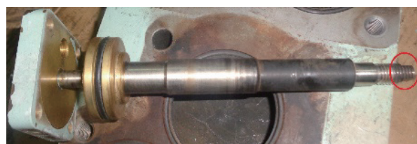
图 8 冷却水选择阀锁紧螺母丢失（圈定处）
