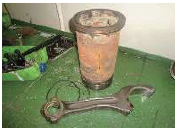
图 3 NO.6 缸连杆变形
