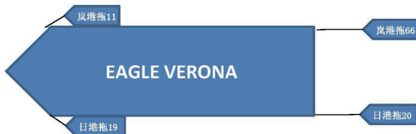
图4 “EAGLE VERONA” 轮拖轮带缆配置图
