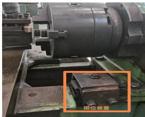
图3 车床限位装置
